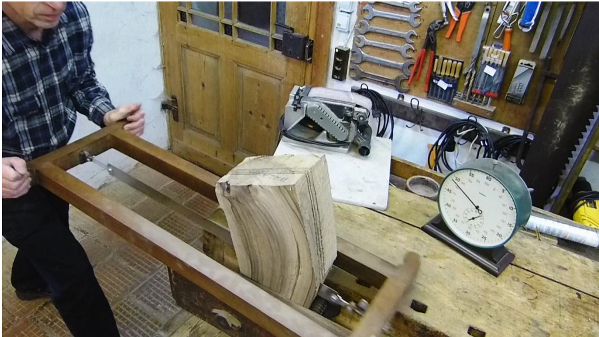
Arbeit mit einer typischen Klobsäge, die bei größeren Objekten von zwei Männern geführt wird
